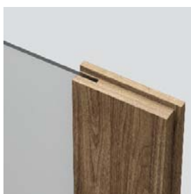
üvegpánél beépítés - falcos ajtóknál
