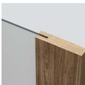
üvegpánél beépítés - falc nélküli ajtóknál
